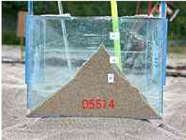
写真-4.現地での安息角の測定例
